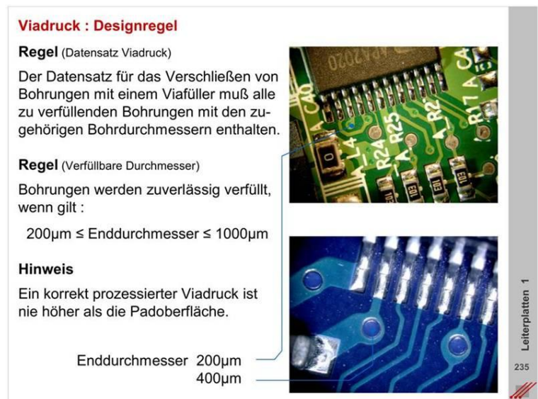
Bild 15-4 Viadruck auf CPU-Boards
